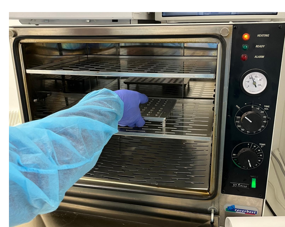
Le RDT saranno inserite in stufa a secco impostata a 110° per 15 minuti
