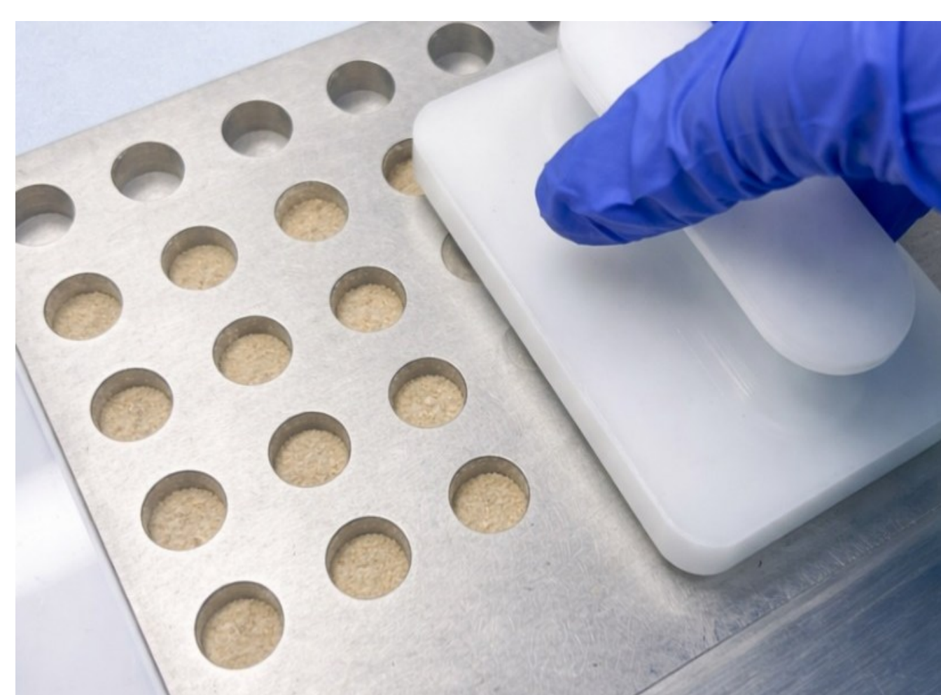
Riempimento della piastra per RDT, alveoli di volume \approx 0,75 mL
